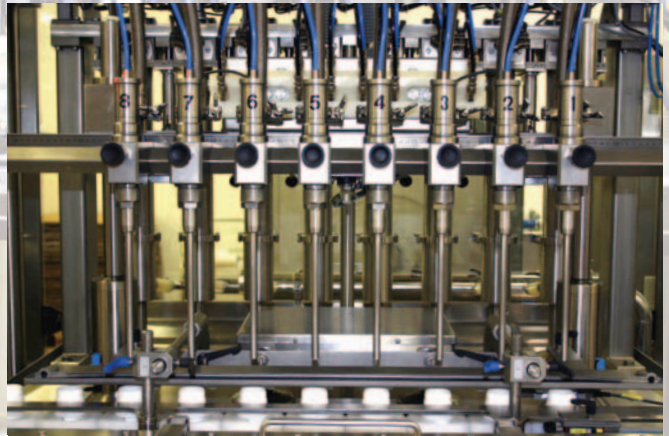
Mit dem servogesteuerten Kolbenfüller sind auch Unterspiegel-Abfüllungen möglich.
